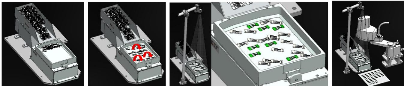
1, 人工加料至储料仓，储料仓振动补料至柔性供料器料盘；
